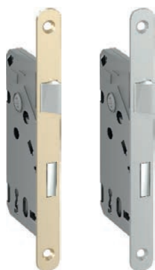
Zámek PRIME: s čelem ve stříbrné nebo zlaté barvě u kolekcí s fólií je západka zámku v barvě matné pozinkované; u kolekcí s přírodní dýhou je západka zámku v barvě stříbrné
