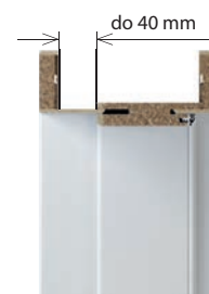
maximum zárubeň s širokým perem za příplatek do 40 mm
