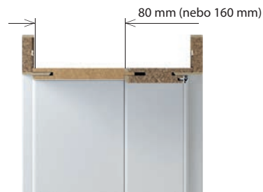
maximum zárubeň s širokým perem za příplatek do 40 mm
