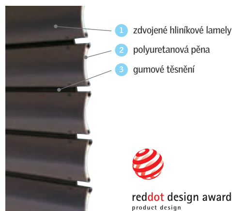
Konstrukce předokenní rolety
